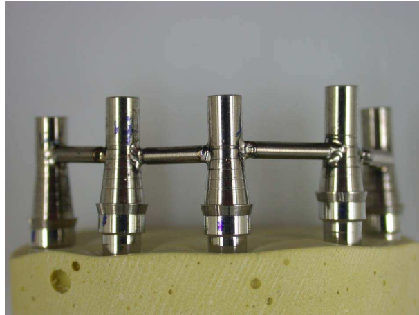
Figura 11:- Estrutura metálica sobre o modelo de gesso pós soldagem
