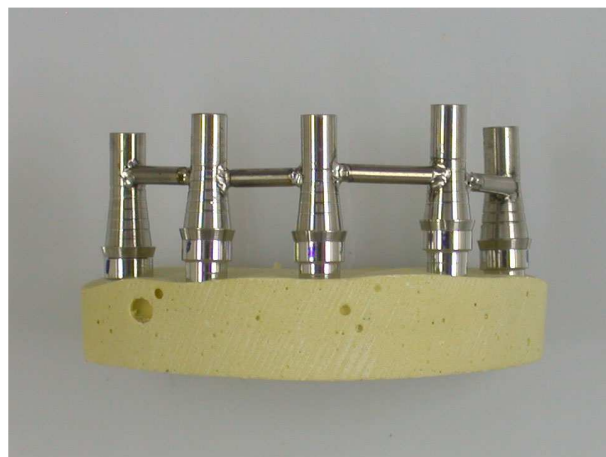
Figura 22:- Verificação do assentamento da estrutura após solda laser sem parafuso de retenção
