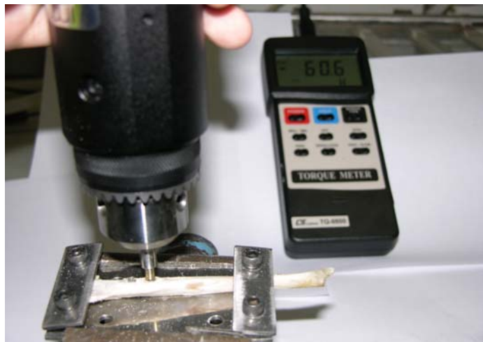
Figura 4.19. Torque de 60,6 Ncm em implante nitretado
