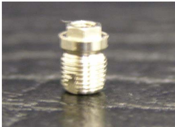
Figura 3.4. Implante nitretado em catodo oco.
