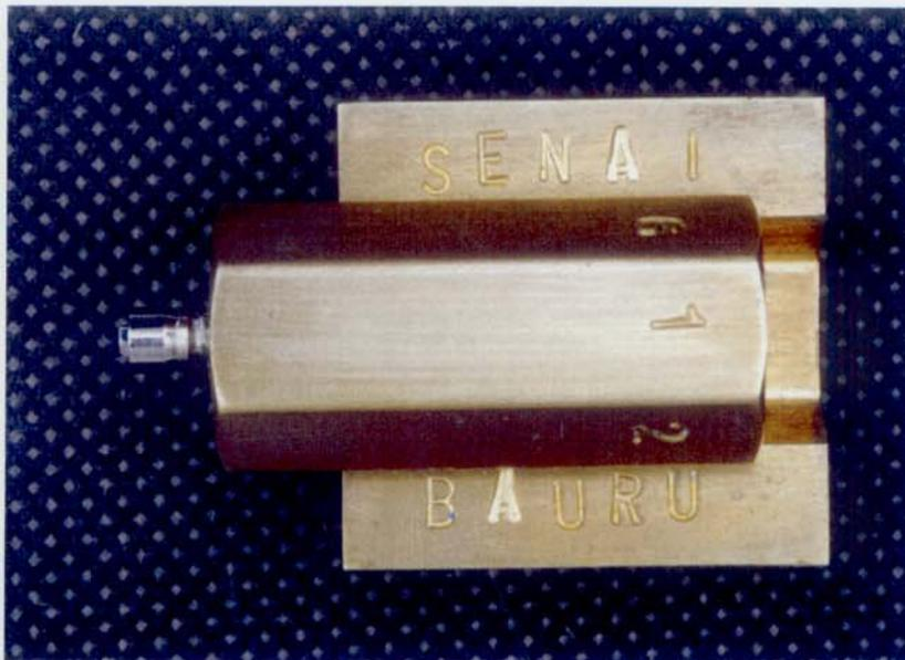
**Figura 2-** Corpo de prova na base com a fixação (SDCA 018-0) e intermediário (SDCA 068-0) em posição
