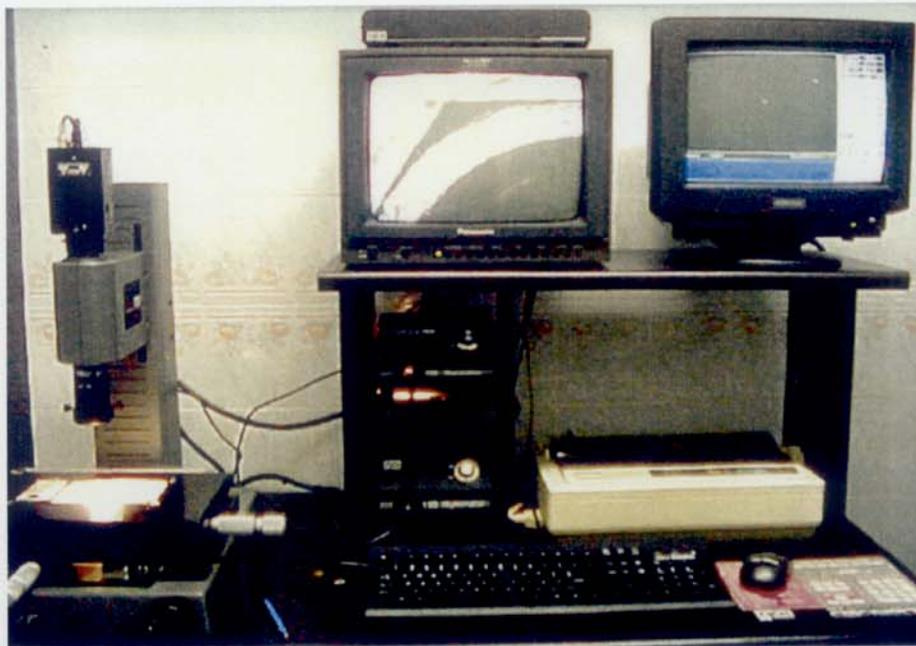
**Figura 3-** Microscópio óptico tridimensional (Ram Optical Instrumentation - modelo Sprint - Irvine, CA, USA)
