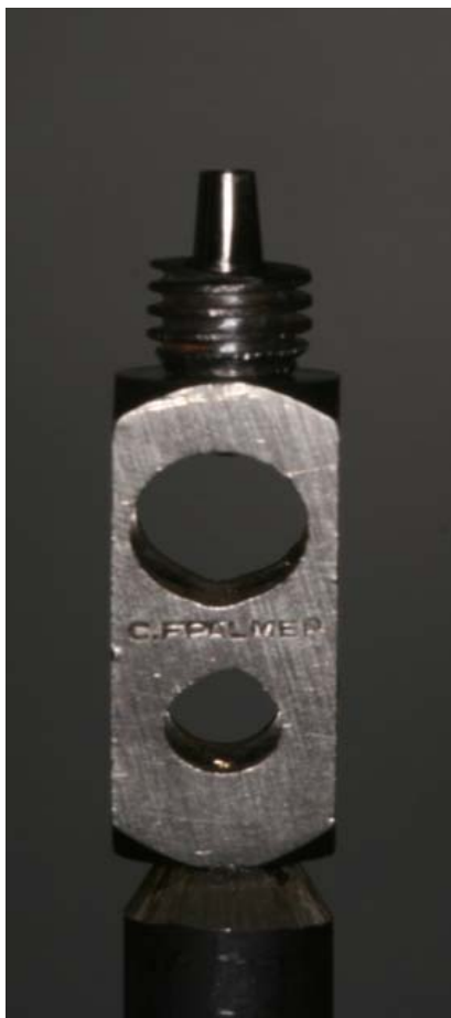
Figura 12. Dispositivo para fixar o conjunto implante/pilar à porção inferior da máquina.
