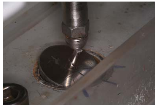
Vista aproximada dos corpos de prova do pilar direto ( fig.6 ) e pilar estético ( fig.7 ) durante a ciclagem dinâmica. Notar o relacionamento entre o pilar e o edentador esférico.
