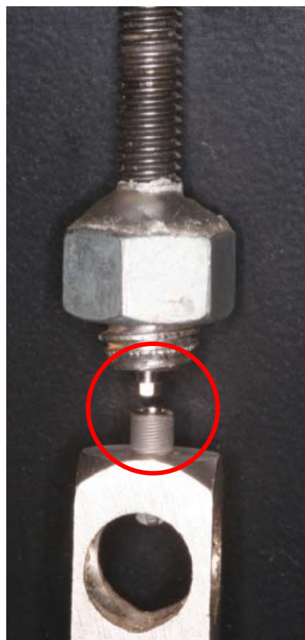
Figura 13. Pilar estético separado do implante após o teste de tração.
