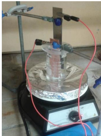
Figura 4- Implantes na placa de titânio e placa de cobre inseridos no Becker com solução de 1 mol/L de \text{H}_2\text{SO}_4 .
