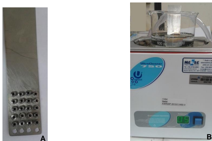
Figura 3 - A) Implantes posicionados em placa de titânio, B) Implantes lavados em ultrassom.
