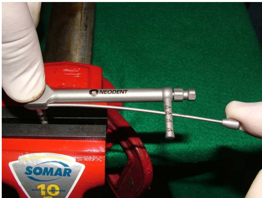
Figura 10. Aplicação do torque recomendado pelo fabricante ao parafuso do pilar protético
