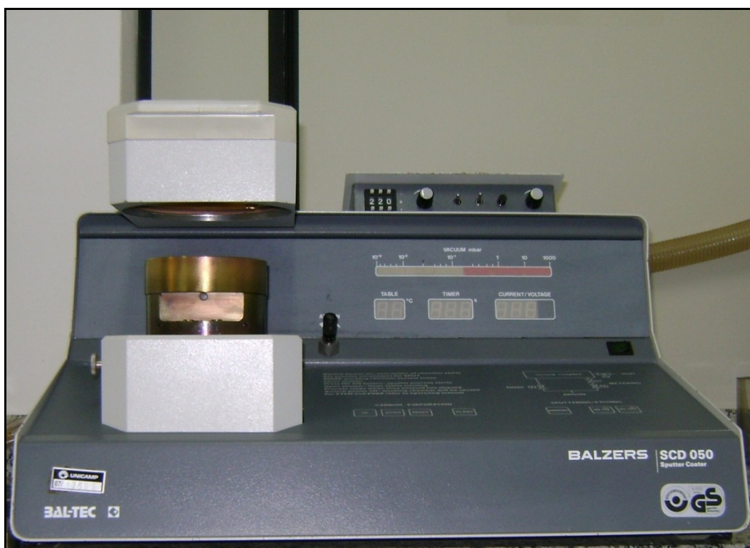
Figura 11 - Máquina utilizada para banho de ouro (SCD 050 Sputter Coater).
