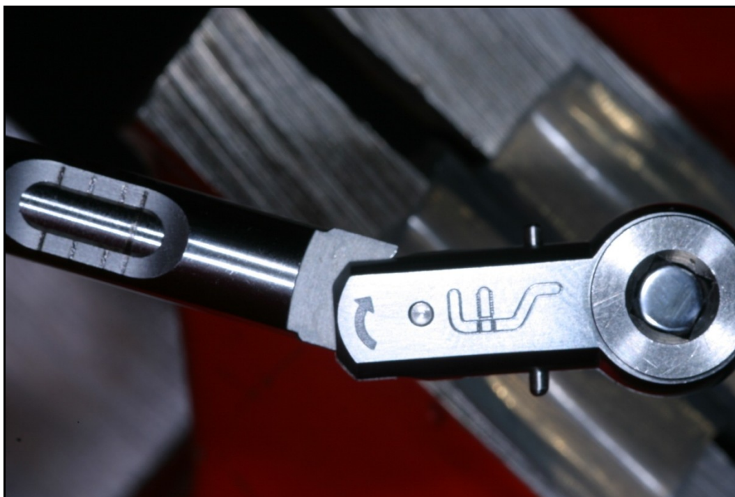
Figura 3 - Aplicação do torque recomendado pelo fabricante.
