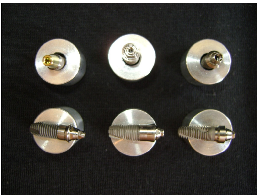
Figura 5 - Posicionamento das amostras para análise em MEV.
