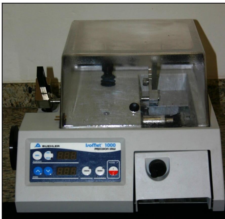
Figura 9 - Máquina de corte utilizada no estudo (Isomet 1000).
