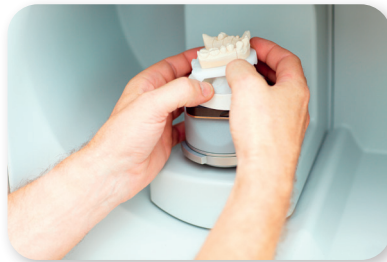
Escaneamento para digitalização do modelo de gesso
