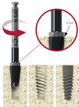
Fresa Cortical en la marca de 0 mm Mayor compresión ósea
