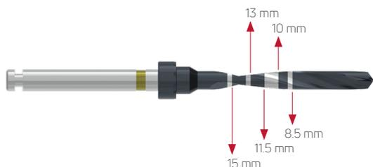
**Indicação:** Fresas helicoidais com stop de fresa, de irrigação externa, marcações a laser, utilizadas para aumento progressivo do diâmetro do alvéolo. Apenas para os implantes **b-fix® Profile** e **e-fix® IT-Profile TX**.
